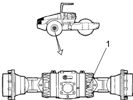
Ölstandsschraube (1) reinigen sowie herausschrauben und kontrollieren, ob der Ölstand bis zur Unterkante der Ölstandsschraubenöffnung reicht. Bei niedrigem Ölstand ist Öl bis zum richtigen Ölstand aufzufüllen. Dabei Getriebeöl verwenden, siehe Schmiermittelspezifikation.
