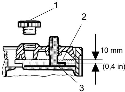
**Abb. Flüssigkeitsstand in der Batterie**
