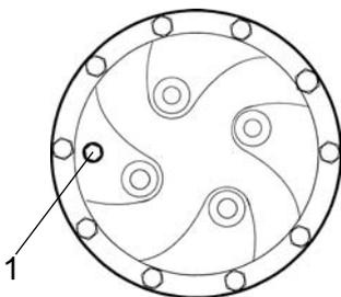
**Abb. Ölstandskontrolle - Planetengetriebe, optional**
