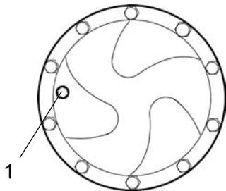
**Abb. Ölstandskontrolle - Planetengetriebe, Standard**
