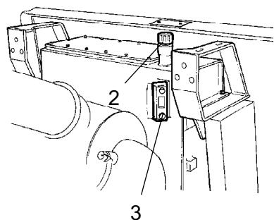
Рис. Бак гидравлической системы
