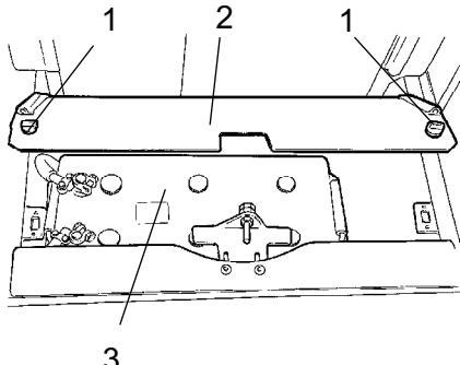
Рис. Кронштейн аккумулятора
