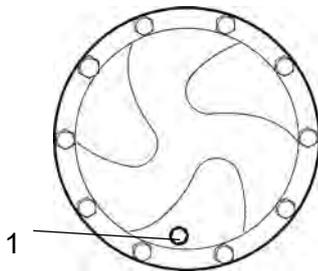
**Fig. Spurgo dell'olio nel riduttore planetario standard**
