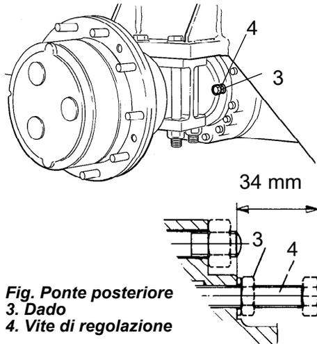
**Fig. Ponte posteriore**
