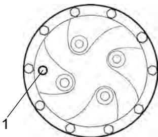
**Fig. Rabbocco dell'olio nel riduttore planetario opzionale**
