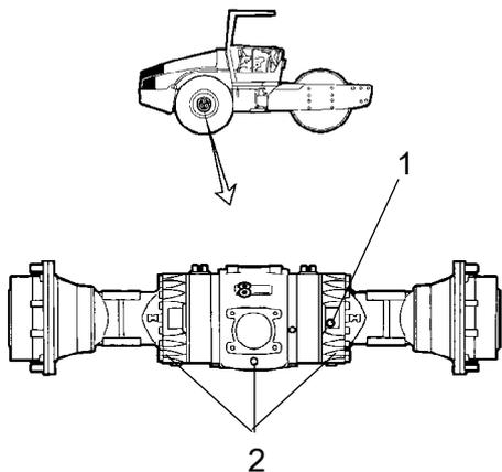
**Fig. Ponte posteriore**
