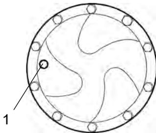
**Fig. Rabbocco dell'olio nel riduttore planetario standard**
