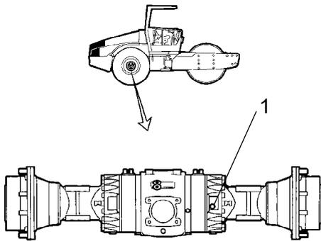
Pulire e togliere il tappo di livello (1) e controllare che il livello dell'olio raggiunga il bordo inferiore del foro del tappo. Se il livello è basso, effettuare il rabbocco fino al livello corretto. Utilizzare olio per trasmissioni, vedere specifiche di lubrificazione.
