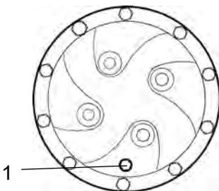
**Fig. Spurgo dell'olio nel riduttore planetario opzionale**
