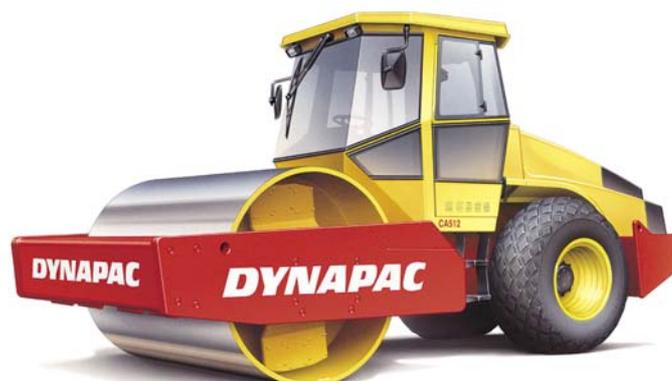
Die CA512 gehört zu den mittelschweren bis schweren Bodenverdichtungswalzen von Dynapac. Diese Maschine ist in D- (Glattmantelwalze) und PD-Ausführung (Stampffußwalze) erhältlich. Die D-Version ist zum Verdichten von Felsgestein vorgesehen. Die PD-Ausführung kommt vor allem beim Verdichten von bindigen Böden und verwittertem Gestein zum Einsatz.
