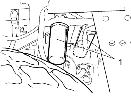
Şekil Motor bölümü 2. Hidrolik sıvısı filtresi (x2).
