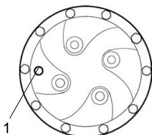
**Fig. Planetario / posición de relleno**
