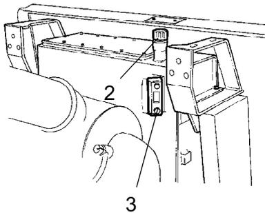
**Fig. Depósito hidráulico**
