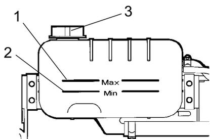
**Fig. Depósito de agua**
