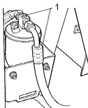
**Fig. Filtro de secado**
