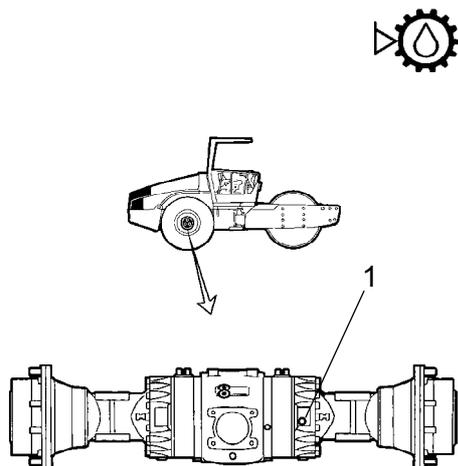
**Fig. Comprobación de nivel - caja del diferencial**
