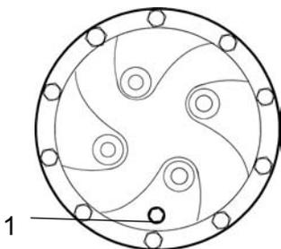
**Fig. Planetario / posición de desagüe**
