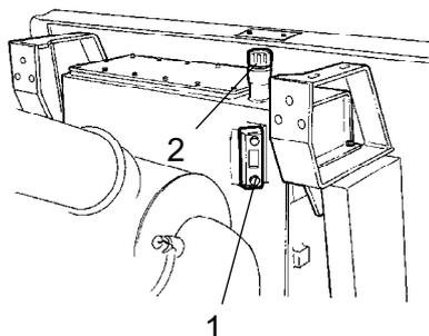
Coloque la apisonadora en una superficie plana y compruebe que el nivel de aceite del cristal transparente (1) se encuentra entre las marcas máx. y mín. Si el nivel es demasiado bajo, rellene con el tipo de líquido hidráulico especificado en la lubricación.
