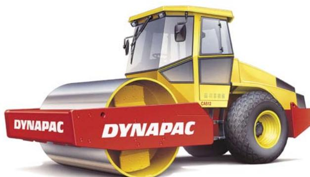
De CA512 is een van de zware grondverdichtingswalsen van Dynapac. Deze wals is leverbaar in de D-versie (gladde wals) en de PD-versie (padfoot). De D-versie is bedoeld voor het verdichten van grove steenslag. De PD-versie is in de eerste plaats bedoeld voor samenhangende materialen en verweerd steenmateriaal.
