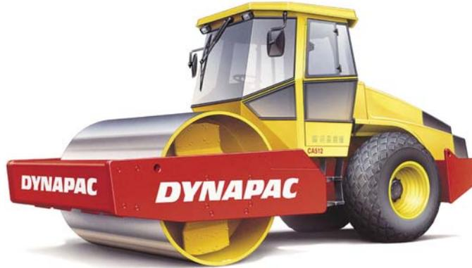
CA512, Dynapac'in ağır toprak sıkıştırma silindirlerinden biridir. D (düz yüzeyli silindir) ve PD (keçi ayaklı silindir) modellerinde mevcuttur. D sürümü, kaya dolguların sıkıştırılması için kullanılır. PD modelinin ana uygulama alanı, yapışkan malzemeler ve kırılmış taş malzemelerdir. Her türlü taban malzemesi ve alt taban malzemesi daha derin biçimde sıkıştırılabilirken D-PD arasında değiştirilebilen silindirler, uygulama alanlarında daha fazla çeşitlilik sağlamaktadır.
