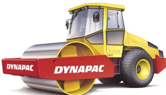
CA602 er en af Dynapacs tunge jordkomprimeringstromler. Den fås i D- (glatvalse) og PD-version (padfod). D-versionen er beregnet til komprimering af sprængsten. PD-versionerne har deres største anvendelsesområde på kohæsive materialer og forvitrede stenmaterialer. Alle typer af bærelag og forstærkningslag kan komprimeres til stor dybde, og de udskiftelige valser, D til PD og vice versa, giver endnu større alsidighed ved valg af anvendelsesområde.
