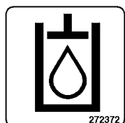
Υγρό υδραυλικού συστήματος
