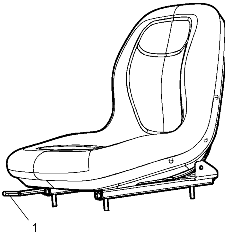
图：操作人员座椅 1. 长度调节
