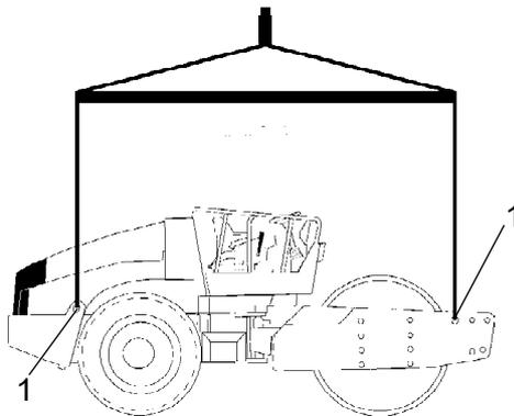
**Fig. Rouleau prêt au levage**
