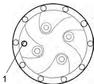
Fig. Réducteur planétaire/position de remplissage
