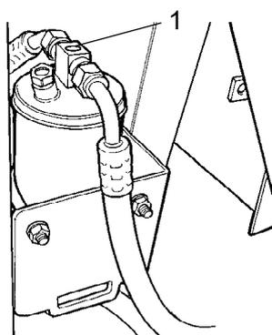
**Fig. Filtre de séchage**
