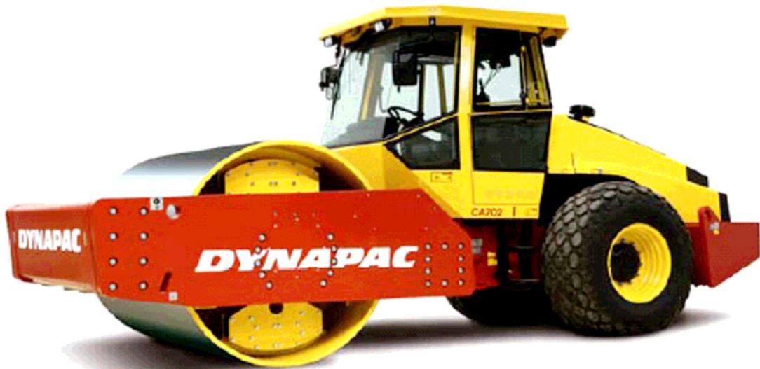
CA702 是戴纳派克公司研制的重型土方压实压路机，有 D 型（光滑钢轮）和 PD 型（凸块式钢轮）两种类型。D 型压路机适用于压实填石，而 PD 型压路机多用于压实粘性土壤。
