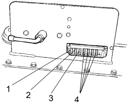
Διαρρύθμιση των ασφαλειών στο γενικό διακόπτη αποσύνδεσης της μπαταρίας στο χώρο του κινητήρα.
