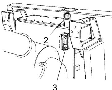
Εικ. Ρεζερβουάρ υδραυλικού συστήματος
