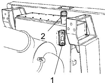
Εικ. Ρεζερβουάρ υδραυλικού συστήματος
