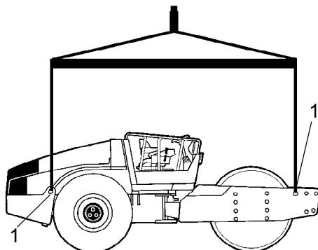
Εικ. Οδοστρωτήρας έτοιμος για ανύψωση
