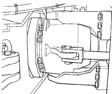
Εικ. Σύνδεσμος συστήματος διεύθυνσης
