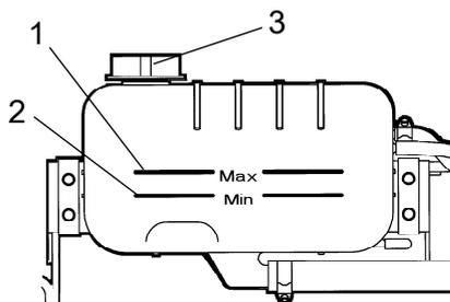
**Fig. Depósito de agua**
