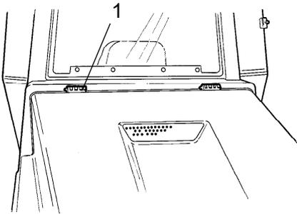
Lubrique las bisagras de la cubierta del motor (1) y los rieles de deslizamiento del asiento del operador con grasa, y las otras juntas y controles con aceite. Lubrique las bisagras de la cabina con grasa. Véase la especificación de lubricación.
