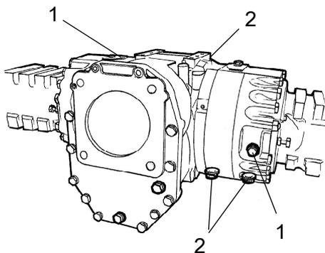
Limpie y retire los tapones de nivel/relleno (1) y los tres tapones de drenaje (2), y coloque el aceite en un recipiente adecuado. Los tapones de nivel/relleno se encuentran en la parte frontal y delantera del eje y los tapones se encuentran en la parte inferior y delantera del eje. El volumen es aprox. de 12,5 litros (13,2 qts).
