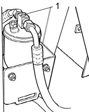
**Fig. Filtro de secado**
