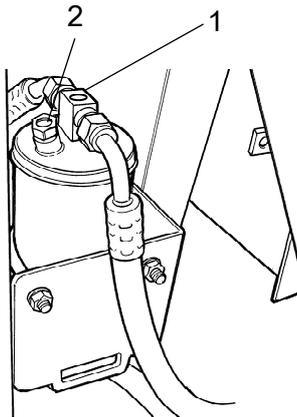
**Fig. Filtro de secado del compartimento del motor**
