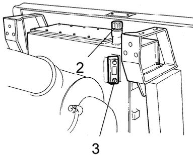
**Fig. Depósito hidráulico**
