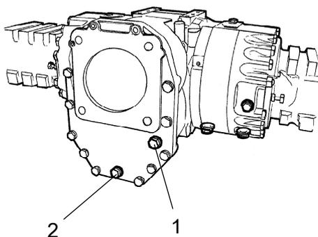
Limpie y retire el tapón de nivel/relleno (1) y los tres tapones de drenaje (2), y coloque el aceite en un recipiente adecuado. El volumen es aprox. de 1,9 litros (2,0 qts).
