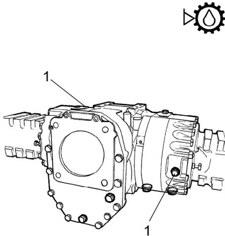
**Fig. Comprobación de nivel - caja del diferencial**
