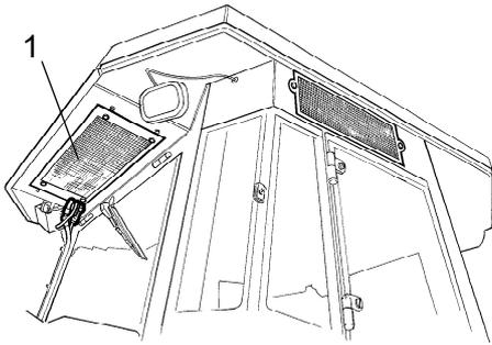
Cuando se reduzca mucho la capacidad de refrigeración, limpie el condensador (1) que está situado en la parte trasera de la cabina. Limpie también la unidad de refrigeración de la cabina. Véase en el encabezamiento 2000 horas, la revisión del control automático de temperatura.
