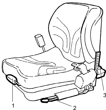
Fig. Posição do operador 1. Inclinação do encosto 2. Ajuste longitudinal 3. Ajuste do peso
