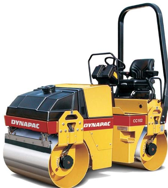
Le CC102 est principalement destiné aux travaux de réparation sur les enrobés mais convient également aux travaux neufs dans des rues étroites, sur la chaussée et les pistes cyclables.
