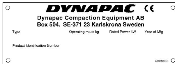
**Veillez indiquer le PIN (numéro de série) de la machine lors de la commande de pièces détachées.**
