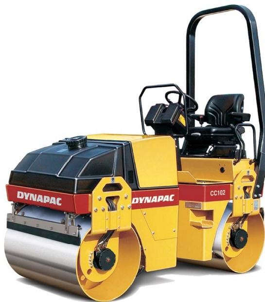
CC102 er i hovedsak beregnet for reparasjonsarbeider på asfalt, men kan også brukes til nylegging på mindre gater, fortau og sykkelstier.
