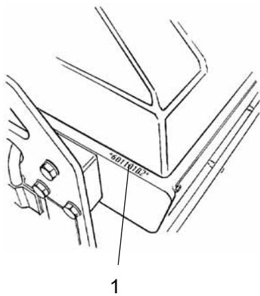
图 : 前车架上的 PIN
