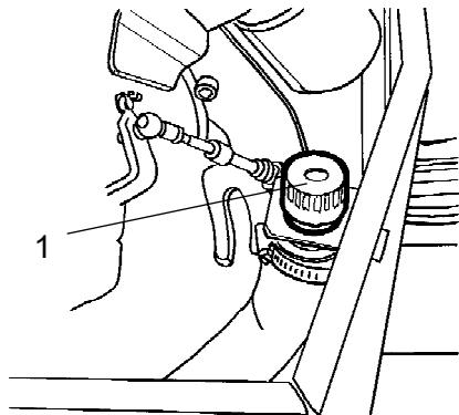
打开发动机罩并拧开加油口盖(1), 如果油位过低加满液压油。
