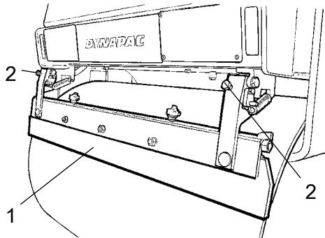
图-弹簧作用刮板
