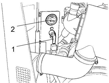
图 - 发动机室 1.蓄电池断路器
