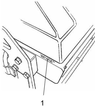
**Abb. PIN am Vorderrahmen**
