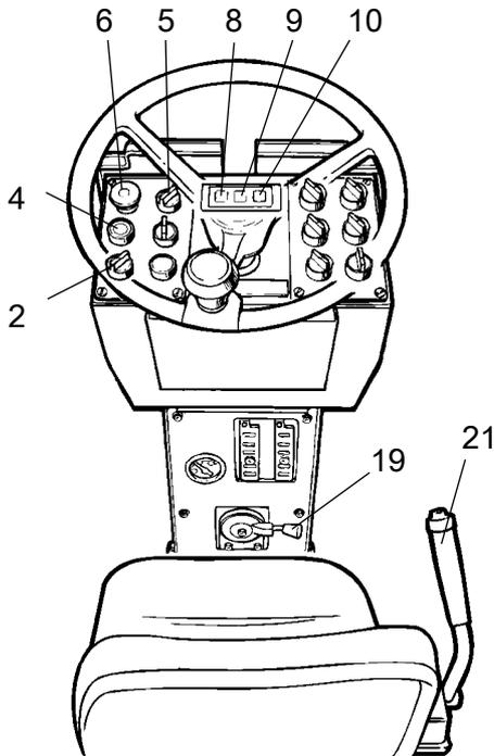
**Abb. Lenksäule mit Instrumenten**
