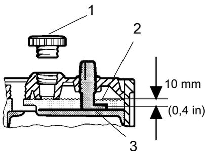
Abb. Flüssigkeitsstand in der Batterie
