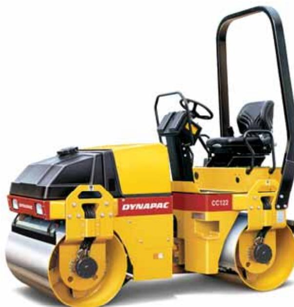
CC122 sind speziell für Reparaturarbeiten von Asphaltflächen vorgesehen, können aber auch beim Asphalteinbau auf kleineren Straßen, Gehwegen und Radwegen eingesetzt werden.
