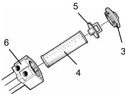
**Abb. Hydraulikölfilter 3. Deckel 4.
