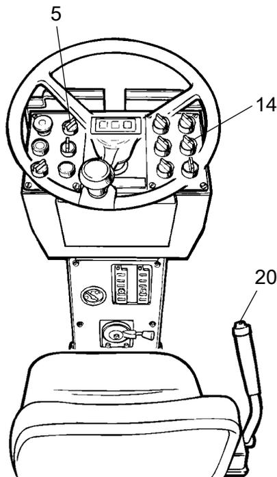
**Abb. Lenksäule mit Instrumenten**
