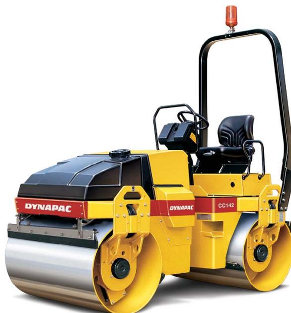
Das Modell CC142 ist eine Walze für den Einsatz im innerstädtischen Bereich und eignet sich für die Verdichtung von Asphalt auf Straßen, Parkplätzen und Industriegeländen. Die Leistung ist ausreichend, um hinter einem kleineren Fertiger die gesamte Verdichtungsarbeit durchzuführen.
