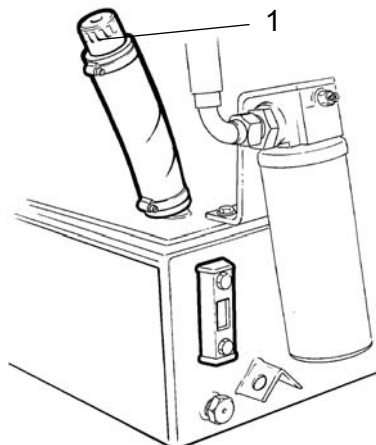
Fig. Motorrum, højre side 1. Beholderlåg
