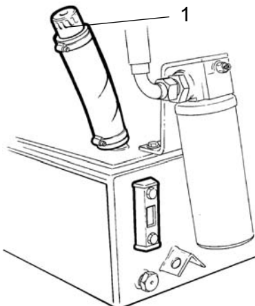
Fig. Compartiment moteur, côté droit 1. Bouchon de réservoir
