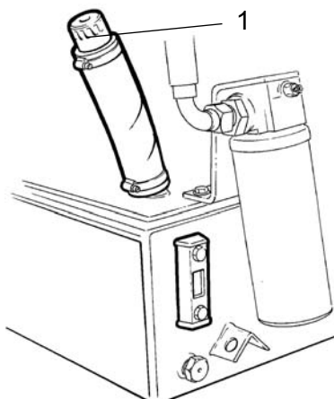
Fig. Motorrom høyre side 1. Tanklokk
