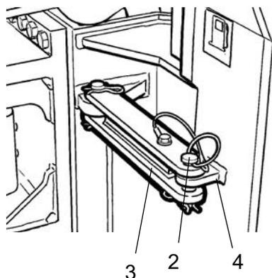
**Fig. Snodo in posizione di blocco**
