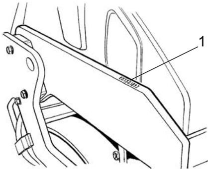
**Fig. PIN sulla sezione anteriore del telaio**
