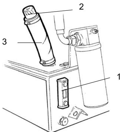
**Fig. Serbatoio idraulico**
