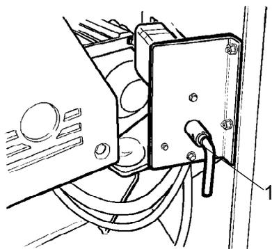
**Fig. Vano batteria (cofano sinistro)
