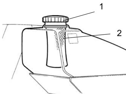
**Fig. Serbatoio dell'acqua posteriore**
