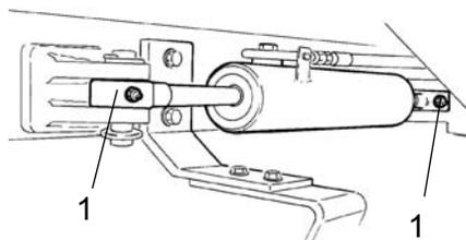
**Fig. Cilindro dello sterzo**
