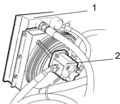
**Fig. Radiatore dell'olio idraulico**
