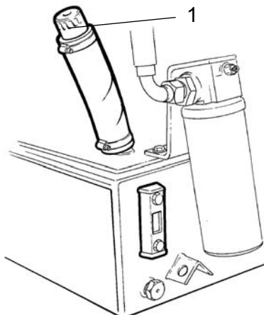
Fig. Motorrom høyre side 1. Tanklokk
