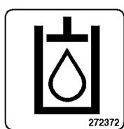
Βιολογικό υγρό υδραυλικού συστήματος
