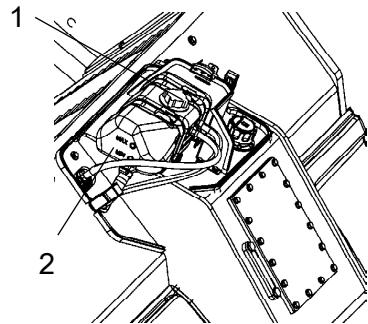
Рис. Расширительный бачок
