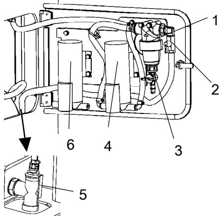
Рис. Насосная система, правая сторона передней рамы
