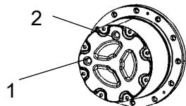
Рис. Привод колеса
