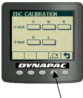
**«EDC CALIBRATION» (Калибровка электронного управления)**
