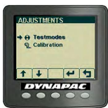
«TESTMODES» (Режимы тестирования) – только для обслуживающего персонала, защищено PIN-кодом.
