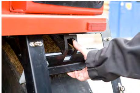
Чтобы опустить скребок, его нужно немножко приподнять и нажать запирающий крюк.
