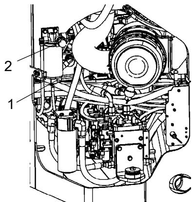
Рисунок. Топливный фильтр
