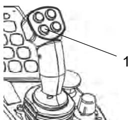
Рис. Рычаг прямого/обратного хода
