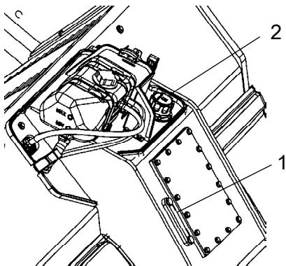
Рисунок. Гидравлический бак
