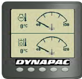
Rys. Ekran temperatury
