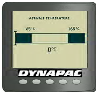
Fig. Ecrã da temperatura do asfalto
