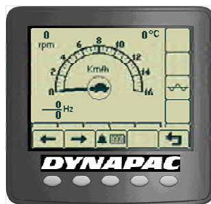
Fig. Il display mostra al centro la selezione (tartaruga o coniglio).
