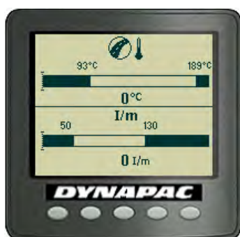
Rys. Temperatura asfaltu/Ekran uderzeniometra
