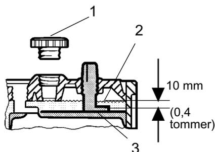
**Fig. Elektrolytniveau i akkumulator**
