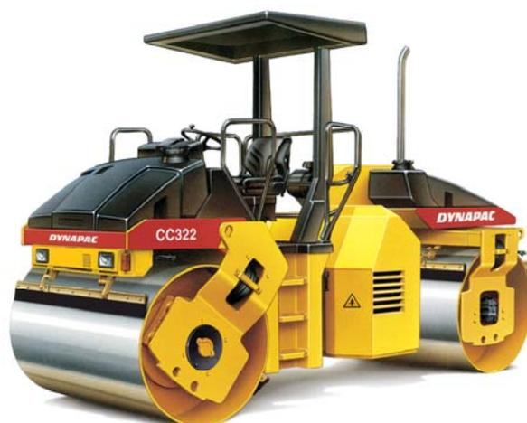
Dynapac CC322 er en 8,5 ton vibrationstromle med ledstyring og bremsesystem og vibration på begge tromler.
