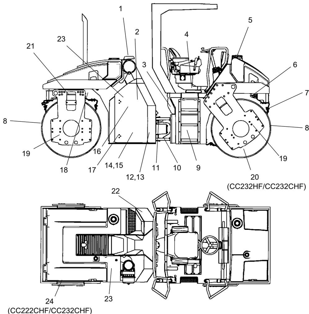
**Fig. Eftersyns- og vedligeholdelsespunkter**
