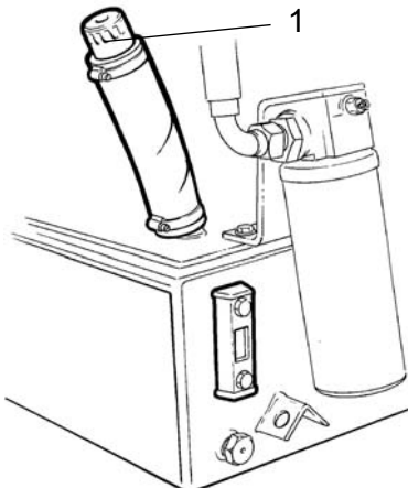
Fig. Motorrum höger sida 1. Tanklock
