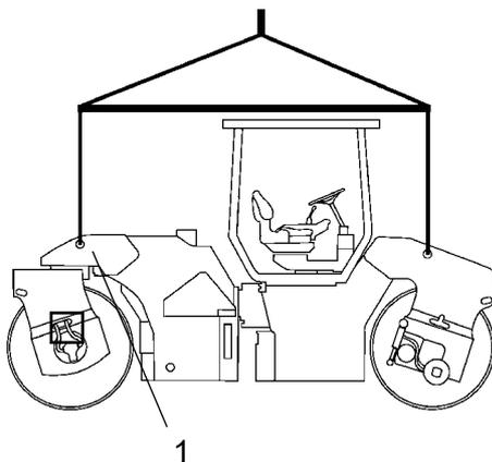
**Fig. Cilindro preparado para ser elevado**
