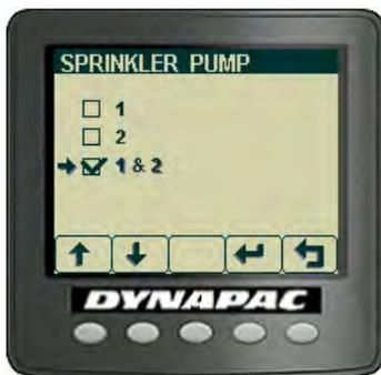
Se a máquina estiver equipada com acessórios, p.ex. espalhador de pedrisco, também se pode modificar as configurações deste.
