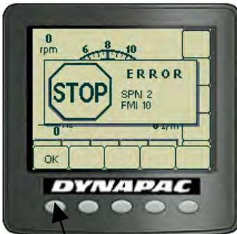
Quando um alarme do motor é ativado, a indicação aparece no visor.
