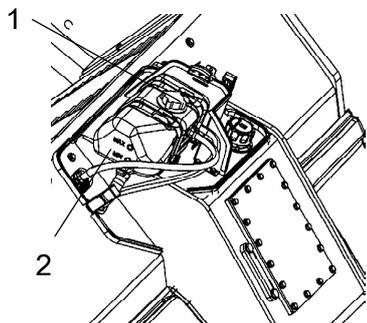
**Fig. Tanque de expansão**
