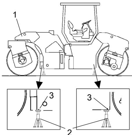
**Figura. Cilindro elevado com macaco**
