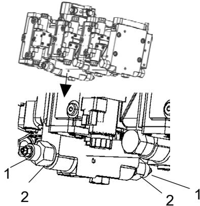
**Fig. Bomba propulsora**
