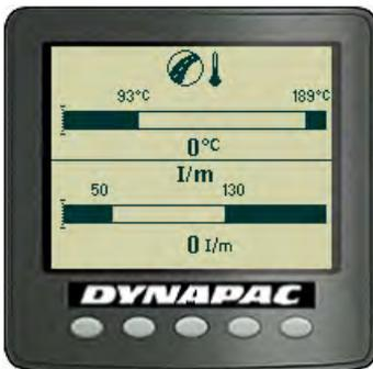
Fig. Tela de temperatura do asfalto/Impactômetro
