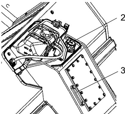
**Figura. Reservatório do óleo hidráulico**
