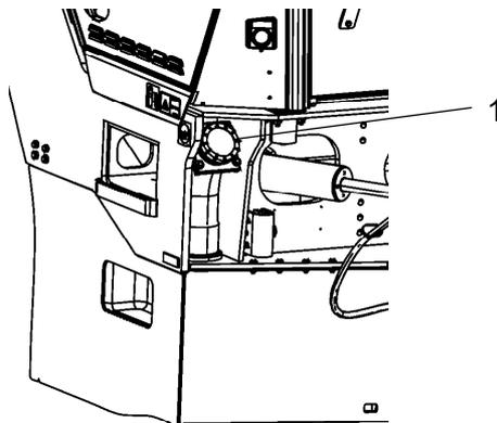
**Figura. Depósito de água padrão**
