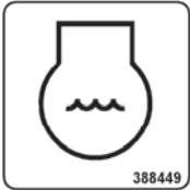
Liquide de refroidissement
