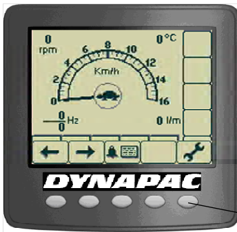
Şekil Menü seçim düğmeleriyle birlikte Ana ekran/Çalışma ekranı (1)
