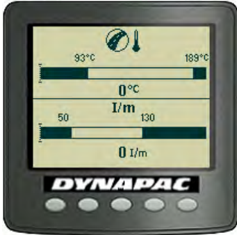
Şekil Asfalt sıcaklığı/Impactometer ekranı
