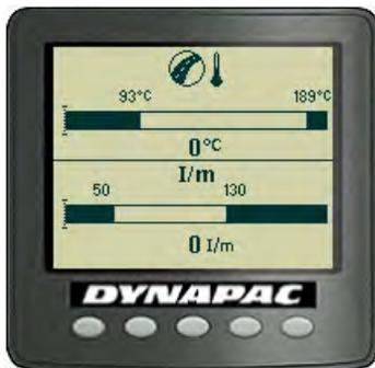
Рис. Экран температуры асфальта/ударного измерителя
