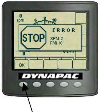
При возникновении аварийного сигнала, касающегося работы двигателя, на дисплее отображается предупреждение.
