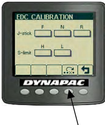
«EDC CALIBRATION» (Калибровка электронного управления)
