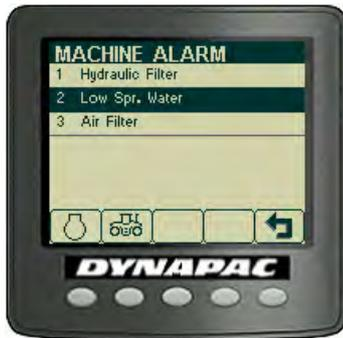
«MACHINE ALARM» (Аварийные сигналы, касающиеся работы машины)
