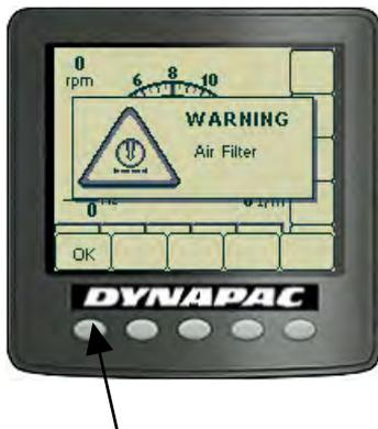
При возникновении аварийного сигнала, касающегося работы машины, на дисплее отображается предупреждение с информацией в виде текстового сообщения.
