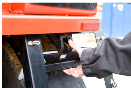
Рис. Скребки колёс 1. Лезвия скребка 2. Запирающий крюк
