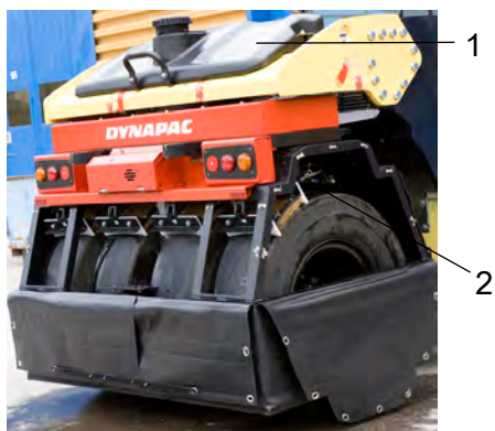
Рис. Рама колеса 1. Задний бак для воды 2. Оросительное сопло
