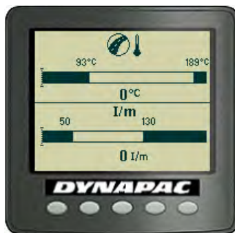
Рис. Экран температуры асфальта/ударного измерителя
