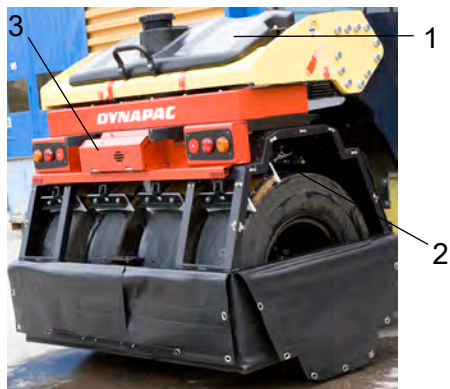
Рис. Рама колеса 1. Задний бак для воды 2. Оросительное сопло 3. Система орошения
