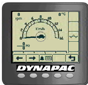
Рис. В центральной части дисплея отображается выбранный параметр (значок черепахи или кролика).
