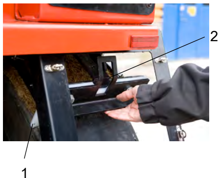
Рис. Скребки колёс 1. Лезвия скребка 2. Запирающий крюк
