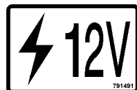
Tension de la batterie
