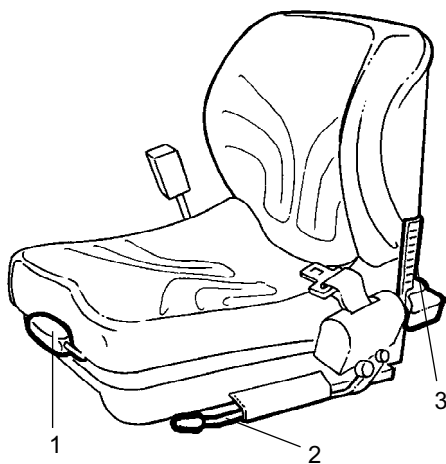
Fig. Operatørposition 1. Ryglæsvinkel 2. Længdejustering 3. Vægtjustering
