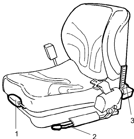
Fig. Positie chauffeur 1. Hoek rugleuning 2. Lengte-aanpassing 3. Gewichtaanpassing
