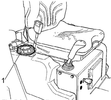
**Fig. Réservoir d'eau**
