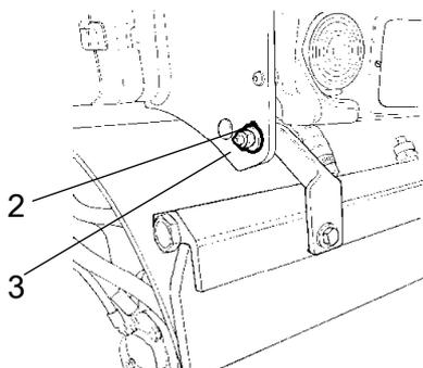
**Fig. Raclours avant en position de transport**
