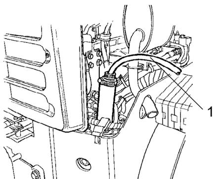
Fig. Réservoir hydraulique
