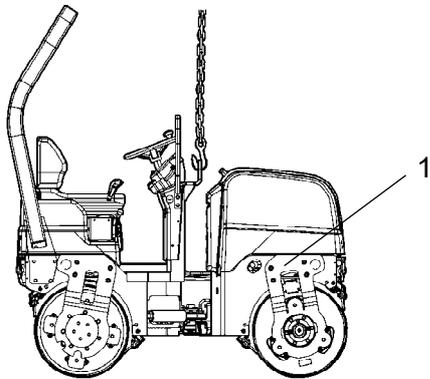
**Fig. Rouleau prêt au levage**
