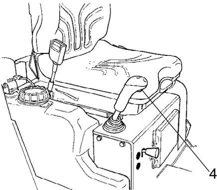
**Fig. Levier de manoeuvre avant/arrière**
