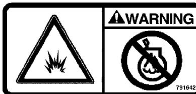
**791642****Atención: gas de arranque****No deberá utilizarse gas de arranque.**
