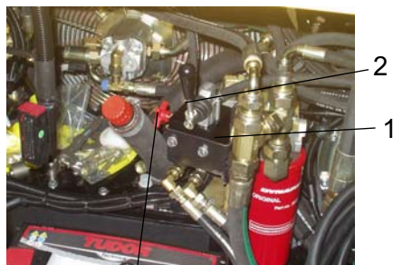
Fig. Soupape pour neutraliser les freins 1. Soupape 2. Bras de pompe 3. Bouton
