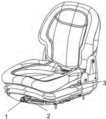
Εικ. Θέση χειριστή 1. Κλίση στηρίγματος πλάτης 2. Ρύθμιση μήκους 3. Ρύθμιση βάρους
