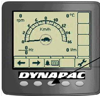
Empfangene Alarmer werden gespeichert/protokolliert und können nach Auswahl von Display Alarms (Alarmer anzeigen) eingesehen werden.
