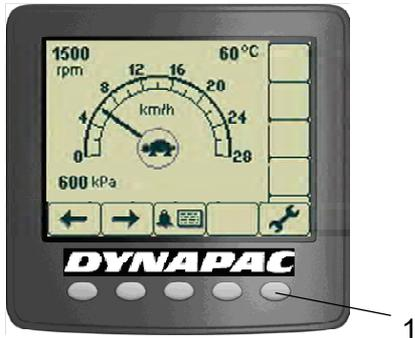
Nach dem Druck eine der Menü-Auswahltasten wird ein Menüfeld angezeigt. Dieses Feld wird für eine kurze Zeit angezeigt und wird nach Ausbleiben einer Auswahl wieder ausgeblendet. Wird erneut auf eine der Menü-Auswahltasten (1) gedrückt, wird das Menüfeld wieder angezeigt.
