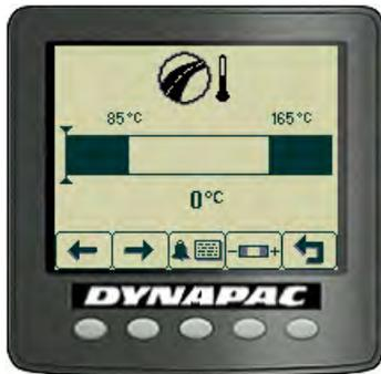
**Fig. Schermata Temperatura asfalto**
