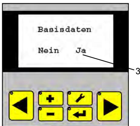
**Abb. Dialogfeld Setup, Zurücksetzen auf Werkseinstellungen**
