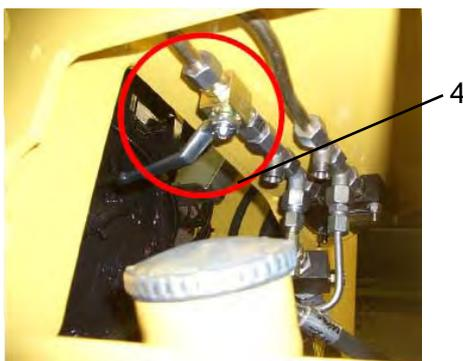
**Abb. 4. Kugelventil geschlossen**
