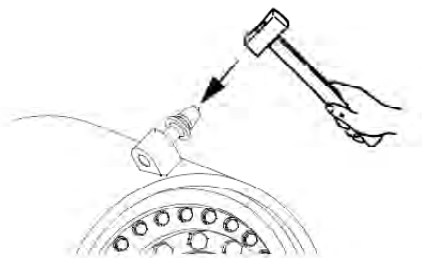
Rys. Wkładanie frezu
